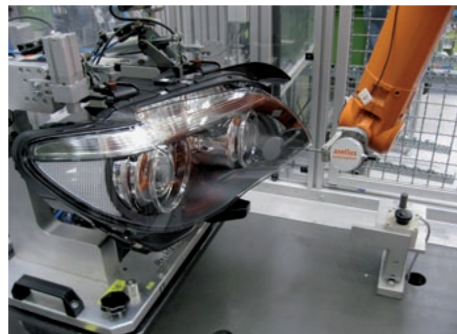
Der Roboter tastet die Messpunkte mit einer hohen Wiederholgenauigkeit ab.
